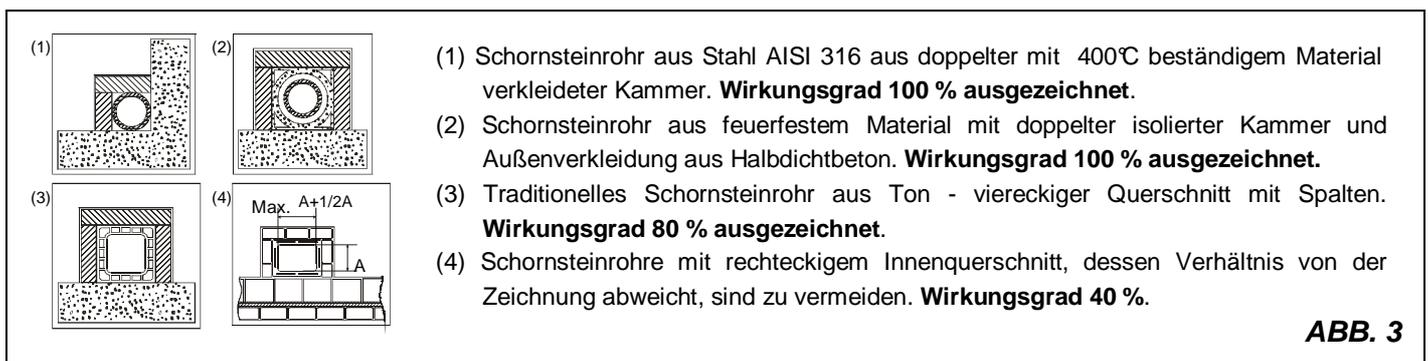
Sollten die Schornsteinrohre einen viereckigen oder rechteckigen Querschnitt aufweisen, müssen die Innenkanten mit einem Radius nicht kleiner als 20 mm abgerundet sein. Was den rechteckigen Querschnitt betrifft, muss das Verhältnis zwischen den Seiten  $\leq 1,5$  sein.
